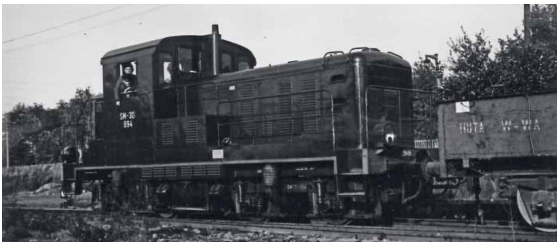
Lokomotywa spalinowa typu 1D (Ls 300 E), w eksploatacji PKP seria SM 30.
