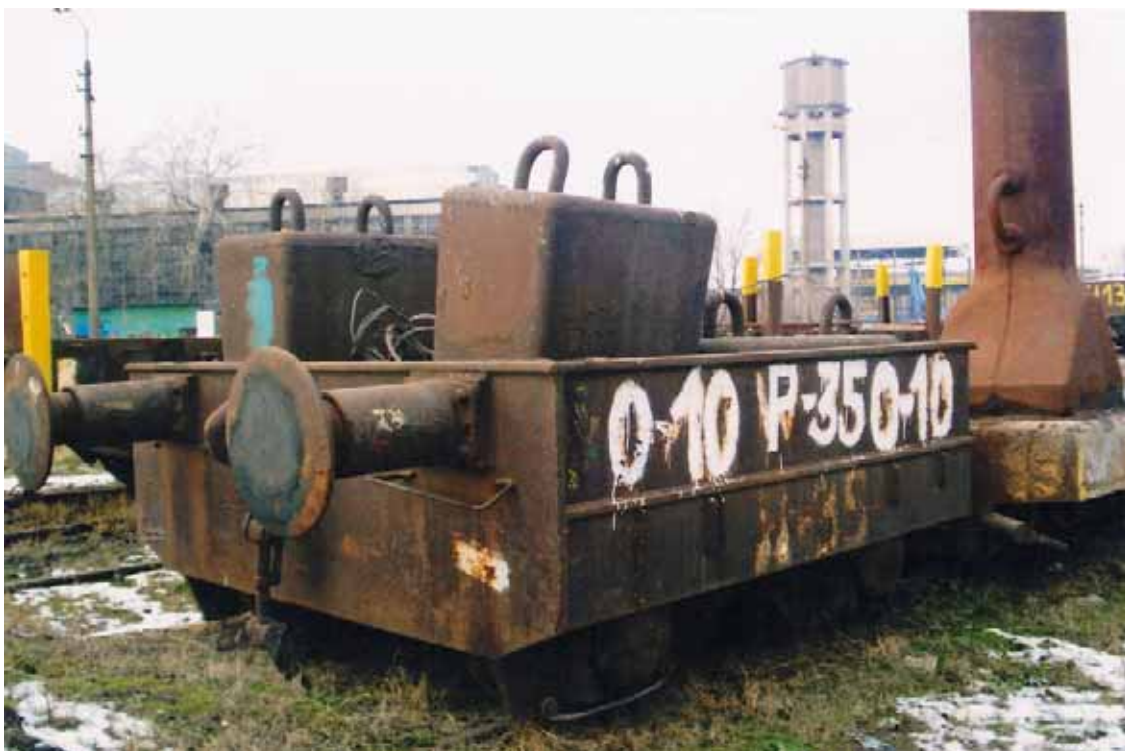
Wycofany z eksploatacji wózek pośredniczący wraz z obciążeniem, a za nim wózek lejniczy wraz ze stojącym lejem do wlewania roztopionej stali. W głębi, z lewej strony hala kuźni, a ze strony prawej nieczynna wieża ciśnień węzła wodnego.
