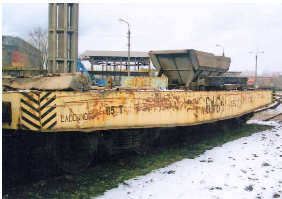
Wagon wewnętrzny nr 6464, o ładowności 65 t, a za nim widoczny dwuosiowy wagon samowładowczy typu talbot.
