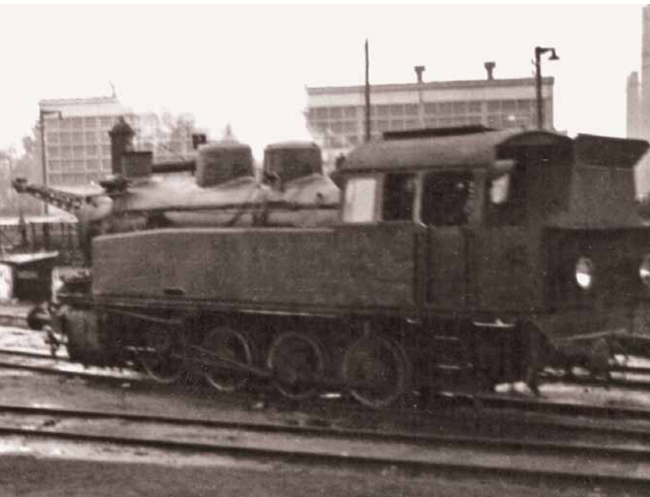
Parowóz TKp 5150 zjeżdża do parowozowni na kanał. W głębi widoczne: lokomotywa spalinowa SM 42-2230, suwnica do nawęglania parowozów i magazynek olejów.
