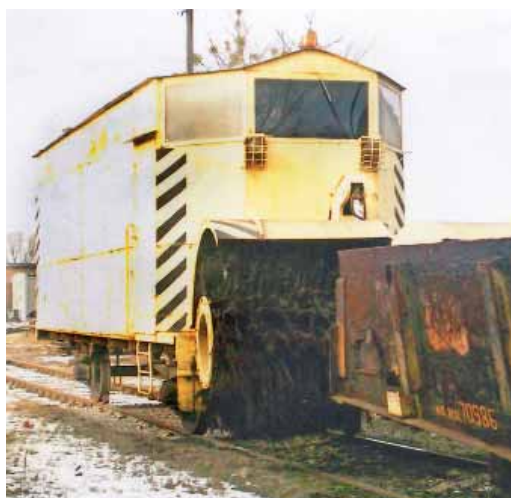
Odśnieżarka wirnikowa zbudowana według dokumentacji inżynierów z Biura Projektów Hutnictwa przez brygadę wagonową Szymona Kajskiego na Wydziale Kolejowym Huty w latach 1996–1997.
