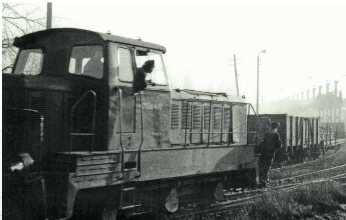
Rozrządzanie wagonów za pomocą lokomotywy spalinowej 401 Da-418 na terenie Huty Warszawa od strony Młocin. Kolej zakładowa Huty Warszawa, marzec 1985 r.
